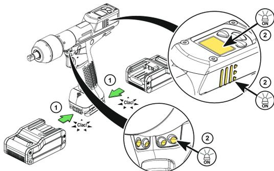
Inserire la batteria sulla parte anteriore o posteriore dell'utensile fino a quando non viene emesso uno scatto.
