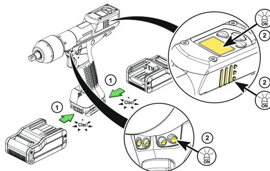
Vložte batériu do nástroja spredu alebo zozadu, kým zreteľne nezačujete zvuk zacvaknutia.
