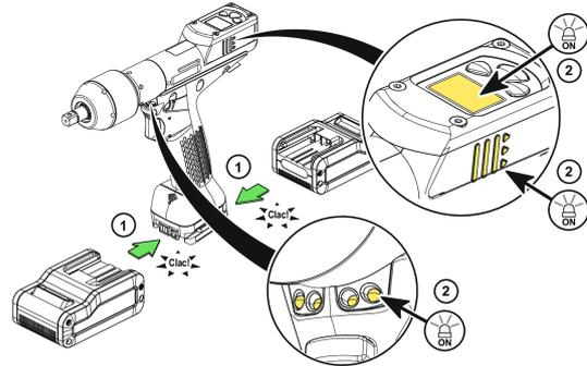
Führen Sie den Akkusatz von vorn oder hinten in das Werkzeug ein, bis ein deutliches Verschlussgeräusch zu hören ist.
