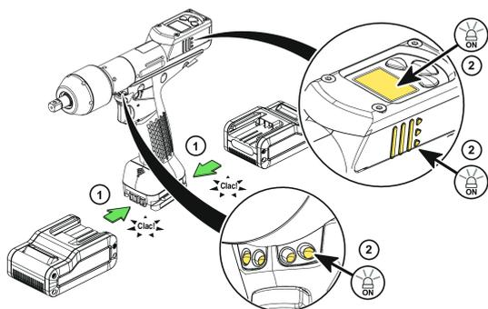
Akumulator należy włożyć z przodu lub z tyłu narzędzia do usłyszenia wyraźnego dźwięku blokady.
