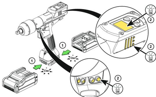
Insérer le bloc-batterie à l'avant ou à l'arrière de l'outil jusqu'à ce qu'un bruit de blocage soit clairement entendu.
