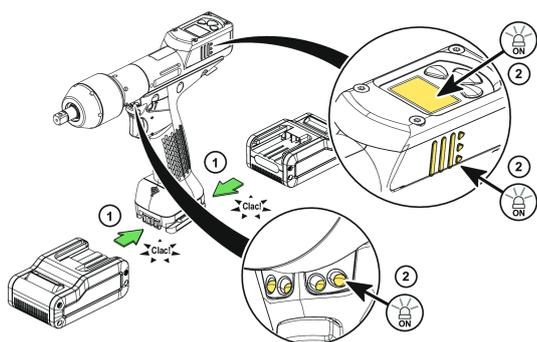
将电池组插入工具的前面或后面，直到听见清晰的锁定声音。
