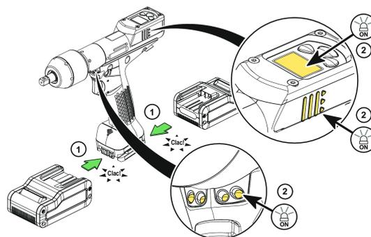
Вставьте аккумуляторный блок спереди или сзади инструмента до щелчка.
