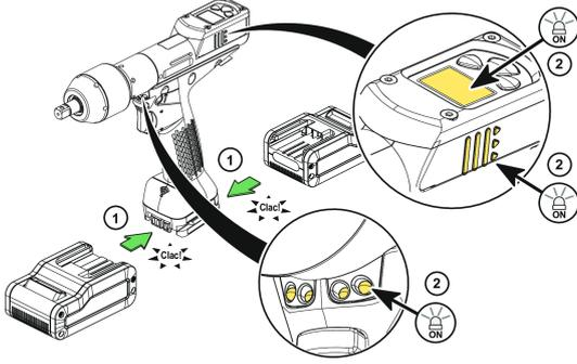
Inserte la batería en la parte delantera o trasera de la herramienta hasta que oiga claramente un sonido de bloqueo.
